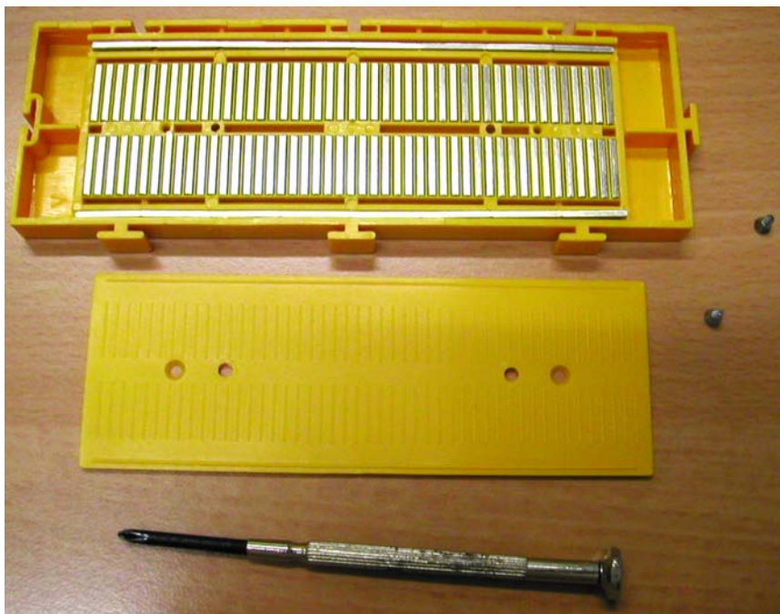
Figura 5. Placa de inserción desmontada en la que se pueden apreciar las tiras metálicas.
