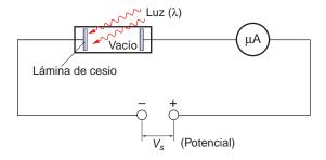
El cátodo de cesio se ilumina con luz monocromática de diferentes longitudes de onda,  $\lambda$ . El potencial de frenado,  $V_0$ , se ajusta hasta que la corriente medida con el microamperímetro se anula. Los resultados que se obtienen son:
