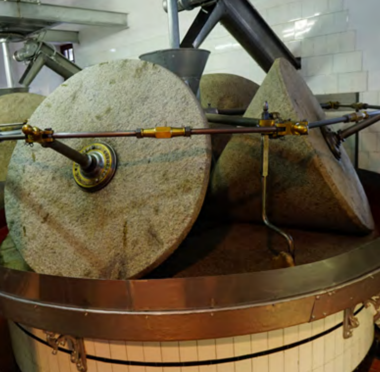
Moulin en pierre avec 3 pierres coniques du moulin à huile Núñez de Prado, Baena.
