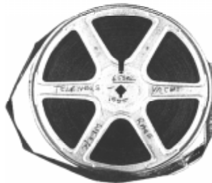
Ilustración 13: Película de cine en 16mm con base de acetato presentando friabilidad y encogimiento.
