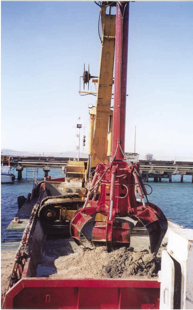
LÁM. VI: Proceso de carga en la draga "Omvac 4".
