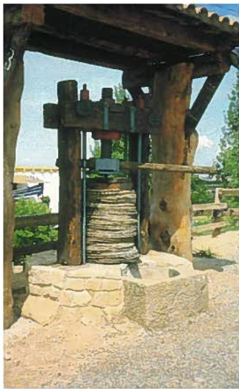
Prensa de piedra y de cuñas de madera. Siglo x. Museo de la Masía Sala.
