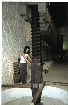
Prensa de viga.
