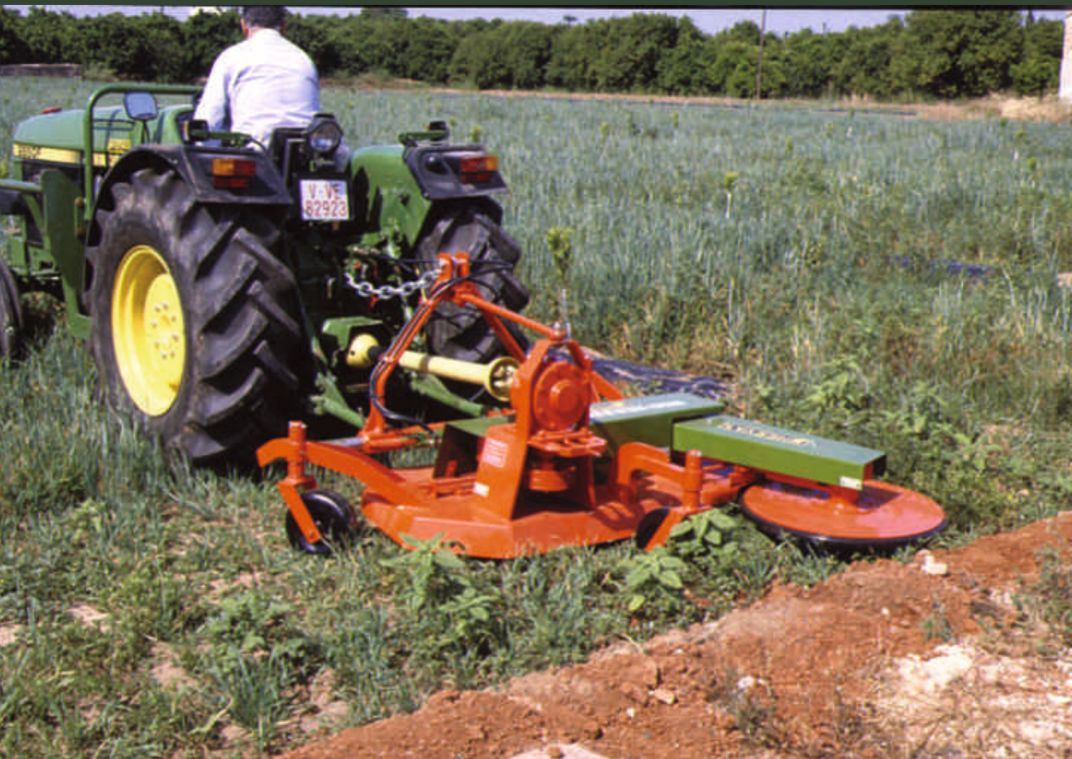
▲ Desbrozadora de tractor, con dos discos fijos y uno móvil, segando una cubierta de veza-avena entre naranjos jóvenes.
