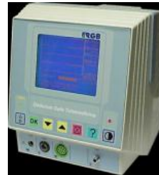
Figura 58. Dispositivos sensores fijos: Sistema Omnicrom Safe.
