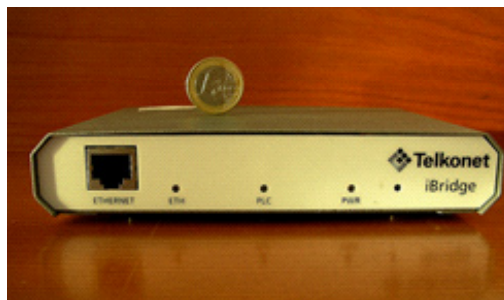
Figura 85: MODEM tipo PLC a Ethernet.
