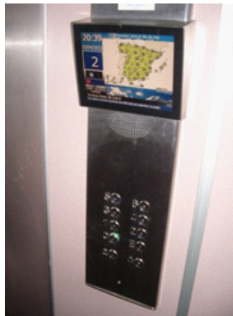
Figura 92: Pantalla de visualización de 10" en ascensor. Conexión con servidor por medio de ADSL.
