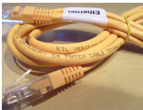
Figura 82: Latiguillo de conexión UTP.
