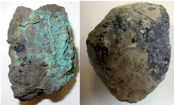
Lám. 7. Minerales de cobre y plomo procedentes de Peñalosa. El primero muestra el característico agrietamiento por efecto del arrancamiento por fuego.
