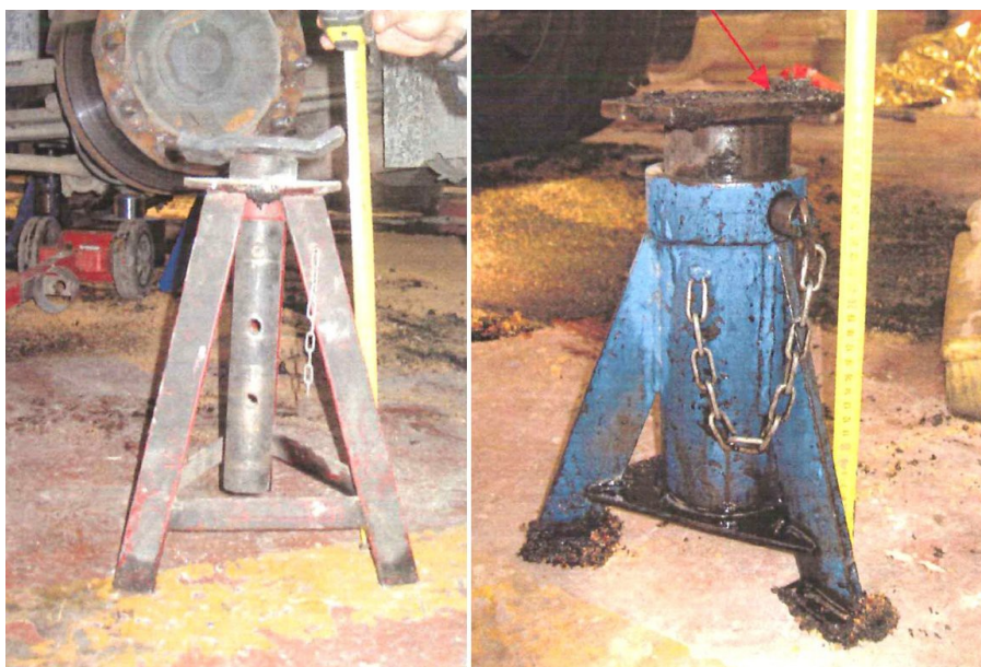
Imagen 1. Caballetes situados en la zona del eje delantero, pero sin sostener ningún peso. No se disponía de ninguna información técnica, marcado CE, o normas de seguridad de los mismos.
