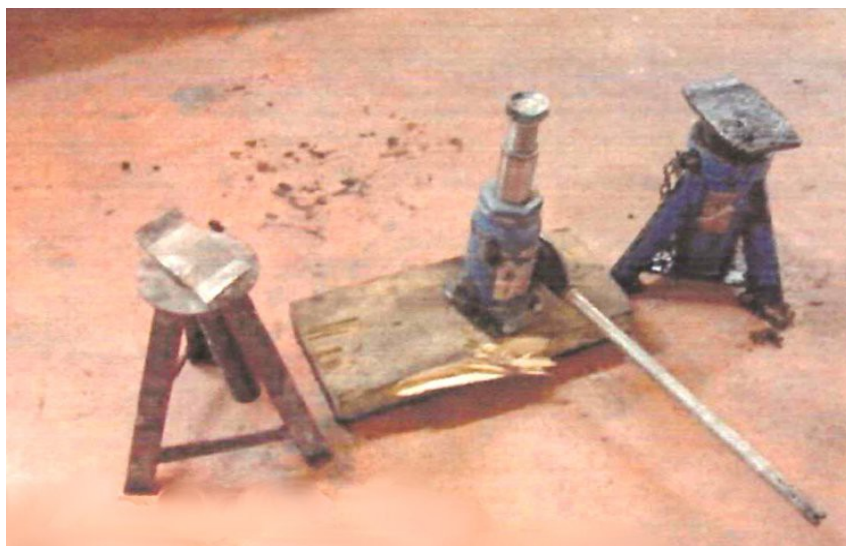
Imagen 2. La altura del gato de pistón sobre el tablón era superior a la altura de los caballetes.
