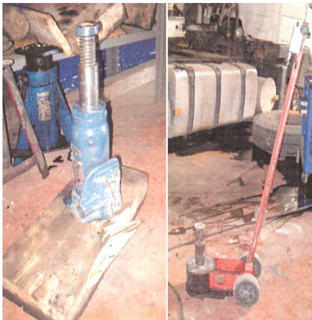
Imagen 5. Gatos en los que se sustentaba el vehículo. El gato azul sobre el tablón que se rompió es el originario del camión y estaba colocado en la parte delantera. El gato rojo oleoneumático estaba situado en el eje trasero.
