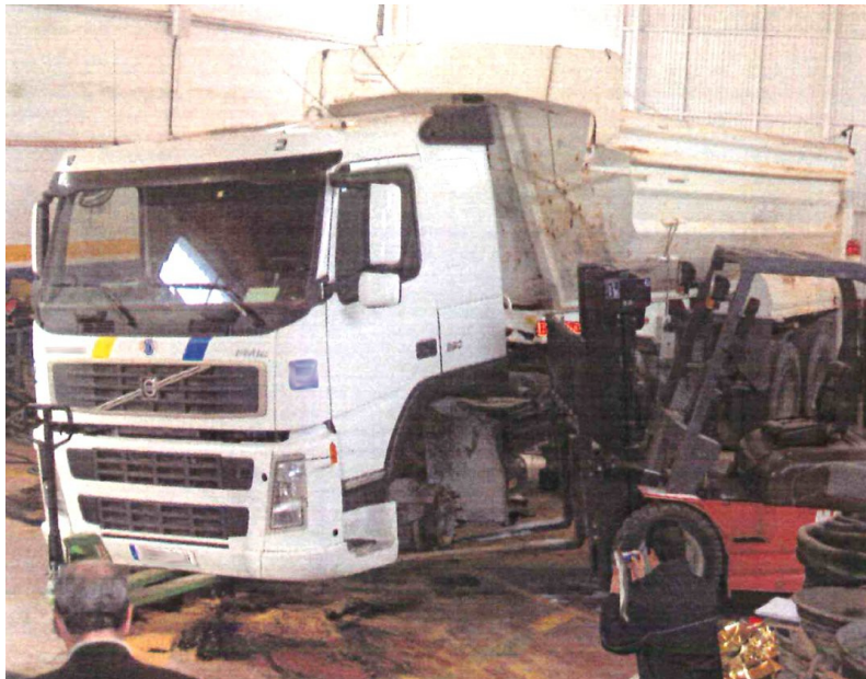
Imagen 3. Remolque y cabeza tractora con las cuatro ruedas retiradas de sus dos ejes bajo la que se produjo el accidente. La carretilla elevadora se utilizó para elevar el vehículo y retirar el cuerpo.
