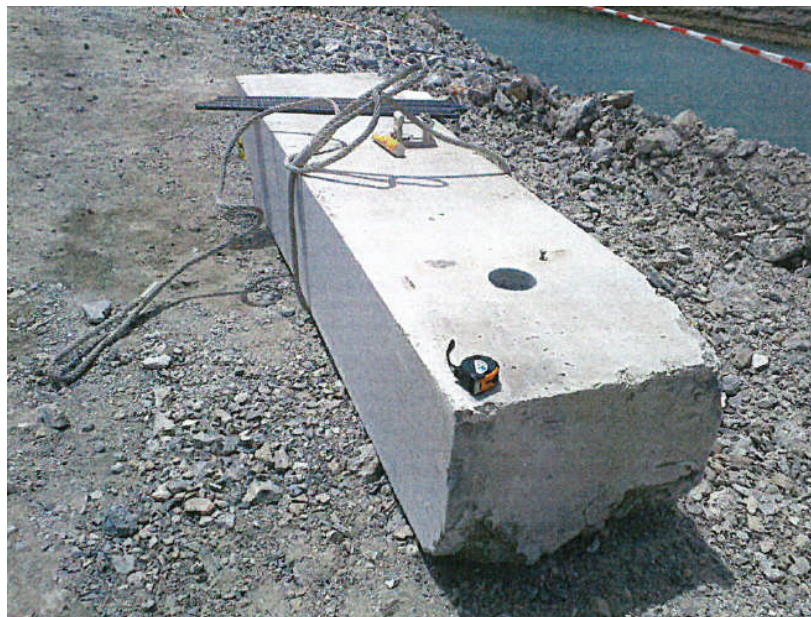
Imagen 4. Uno de los trozos del bloque de hormigón que se desplomó dentro del casetón
