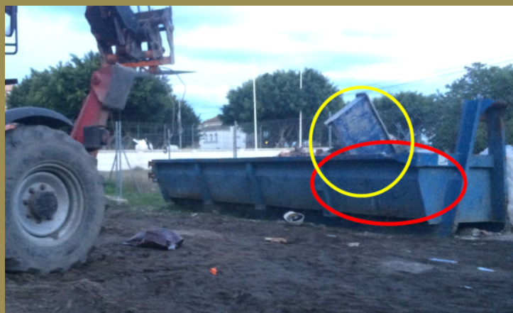
Lugar del accidente. En rojo, donde quedó atrapado el operario. En amarillo, cubeta que se iba a descargar.
