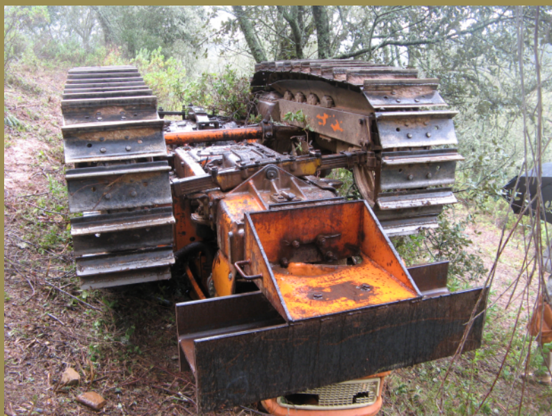
Vista frontal del tractor volcado. El trabajador quedó atrapado debajo al carecer de cabina o estructura de protección.
