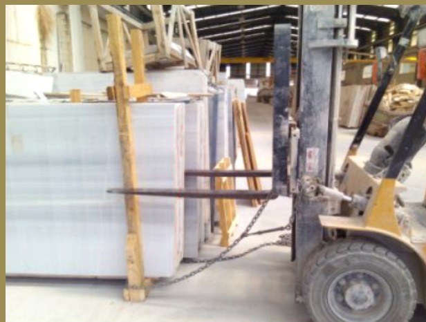
Caballote de placas del mármol entre las horquillas y cadena con que amarran la base.
