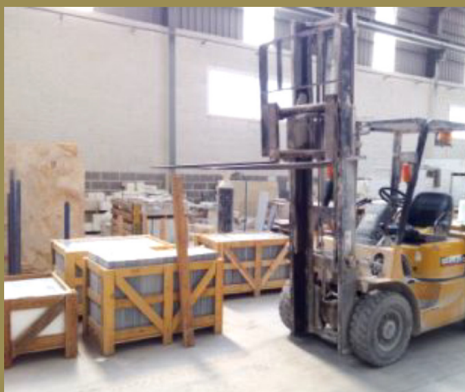
Carretilla utilizada y altura de las horquillas en el momento del accidentado.
