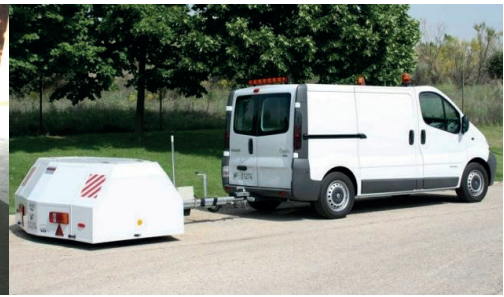
ENSAYO CPX CON TRAILER. FUENTE: CEDEX.
