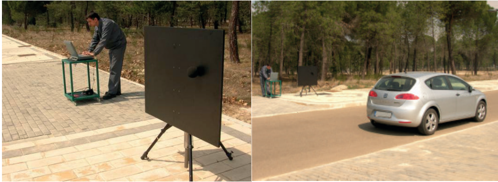
MÉTODO DE MEDIDA SPB-BB VARIANTE BACKING BOARD.
