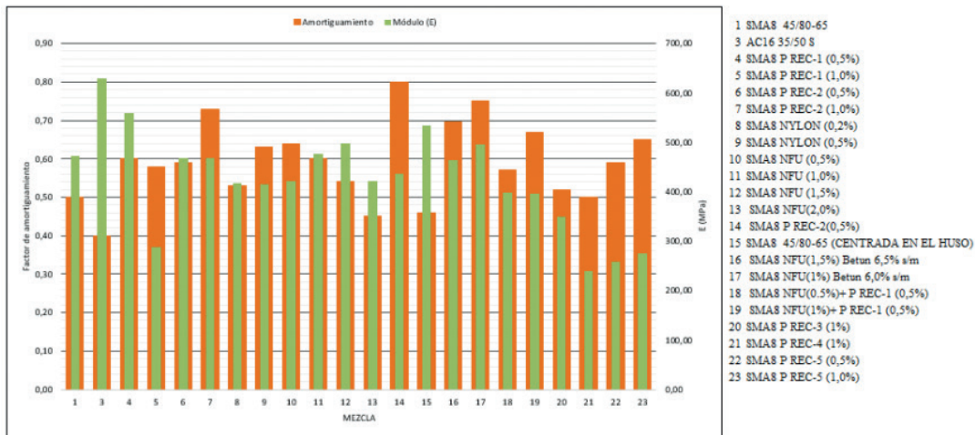
RESULTADOS DEL ENSAYO DE IMPEDANCIA MECÁNICA
