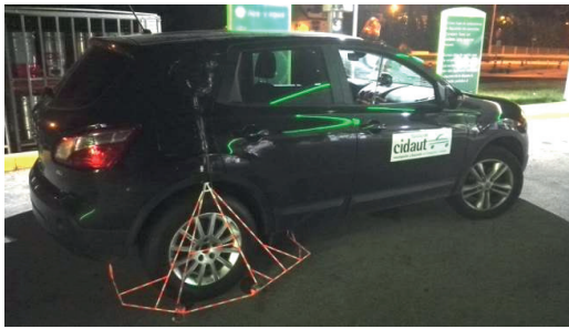
ENSAYO CPX CON VEHÍCULO AUTOPROPULSADO. FUENTE: FUNDACIÓN CIDAUT.
