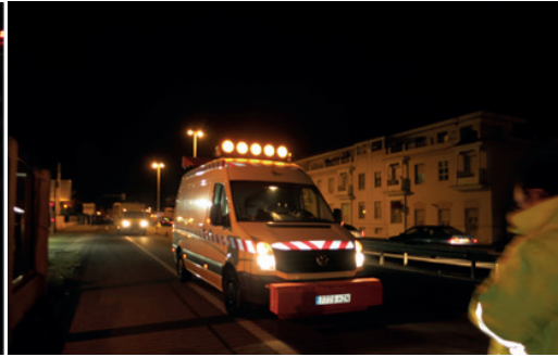
VEHÍCULO DE AUSCULTACIÓN PARA IRI Y MACROTEXTURA
