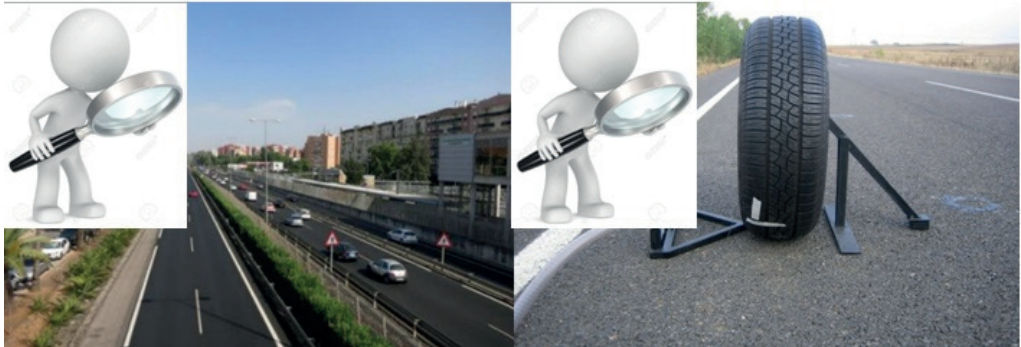
(IZDA.) MÉTODO SPB: VALORACIÓN GLOBAL DEL RUIDO DE TRÁFICO GENERADO EN UNA CARRETERA. (DCHA.) MÉTODO CPX: VALORACIÓN DEL RUIDO DE RODADURA
