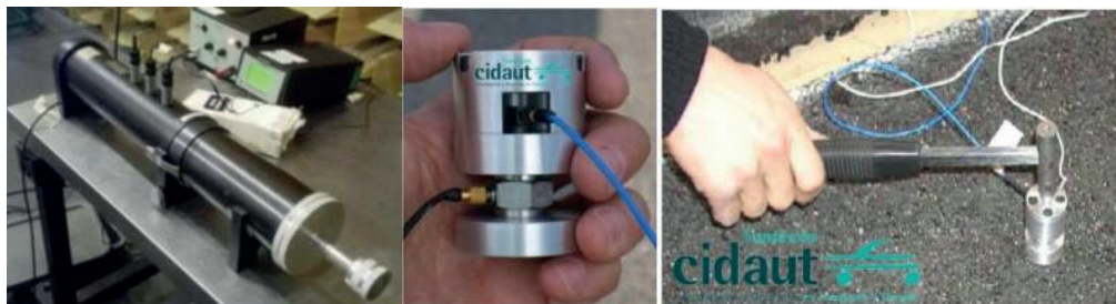
EVALUACIÓN ACÚSTICA DE PROBETAS. TUBO DE KUNDT (IZQUIERDA). IMPEDANCIA (CENTRO Y DERECHA)
