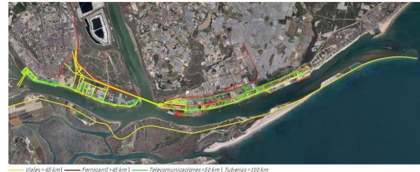
Ilustración 59: Viales (amarillo), líneas de ferrocarril (rojo) y telecomunicaciones (verde) del Puerto de Huelva
