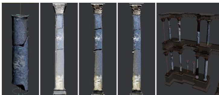
Fig. 3. Proceso de escaneado: nube de puntos - triangulación - mallado - texturizado. 2010.
