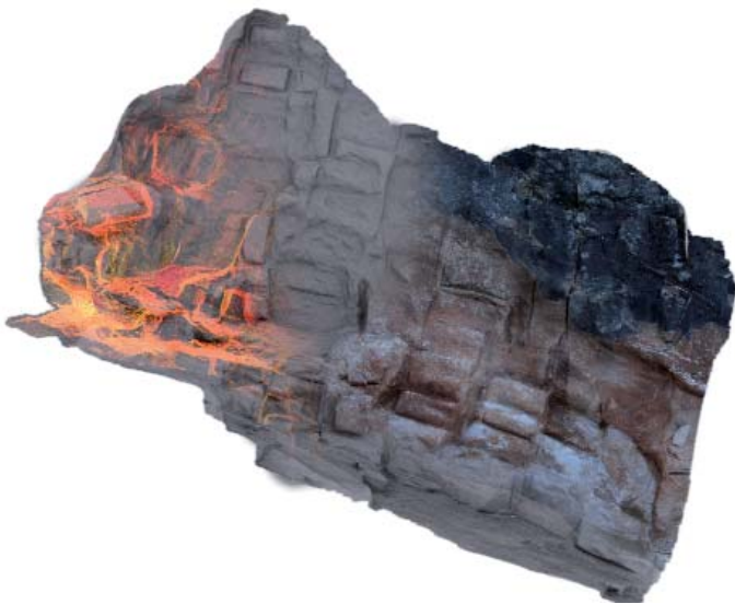
Fig. 12. Montaje en 3D del locus de Los Covachos (Almadén de la Plata, Sevilla), mediante escaner-laser, con distinto grado de tratamiento de izquierda a derecha (puntos, malla y textura de imagen). Elaborado por TCA Geomática (Sevilla).
