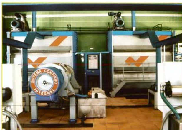
NAVE DE FABRICACIÓN (TERMOBATIDORAS Y CENTRIFUGACIÓN HORIZONTAL)
