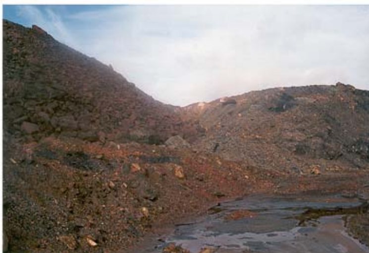
Fotografía 2. Aguas ácidas fluyendo desde una escombrera en una explotación de sulfuros (Tharsis, Huelva)
