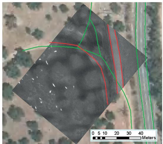
**Figura 9.** Diferencias posicionales y limitaciones geométricas de una de las imágenes georreferenciadas (elementos en rojo) vs. ortofotografía PNOA (verde).
