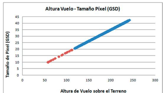
**Figura 4.** Control de geometría del vuelo. Relación entre alturas de vuelo sobre el terreno y tamaño de píxel (GSD) obtenido para cada imagen. En rojo posiciones del UAV en despegue y ascenso hasta altura planificada.
