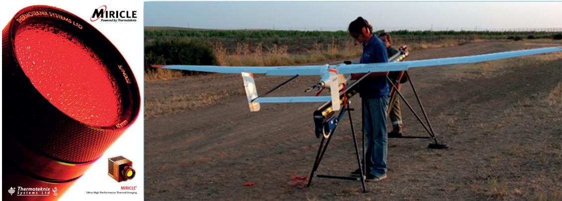
Figura 2. Izquierda: Cámara térmica utilizada. Derecha: Plataforma “E-300 Viewer” utilizada para la captura de imágenes en momentos previos a su despegue (lanzamiento).
