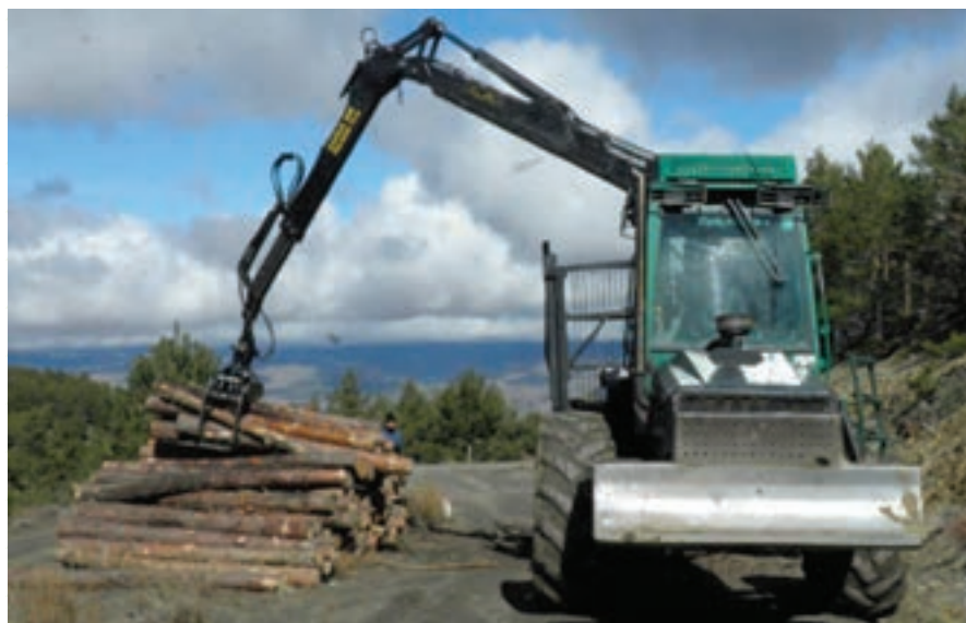
Recogida de madera de tratamientos selvícolas de naturalización de pinar mediante autocargador.
