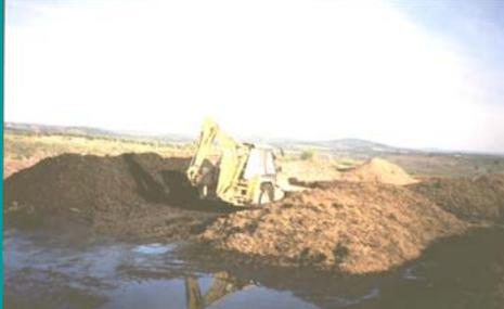
*Tipo de sistema viene condicionado por volumen de materia prima a compostar. El más usual es el sistema abierto con aireación por volteos con pala cargadora. (“windrows”)*
