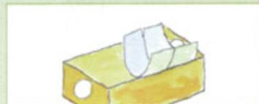
Colocar los cartones con el aluminio hacia afuera, dándoles forma curva bajo el tubo (para que reflejen mejor la luz).
