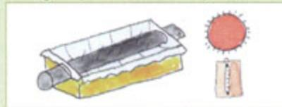
Ponerlo al sol con un termómetro dentro del tubo y comparar la temperatura con la exterior. Podemos asar un tomate, salchicha ...
