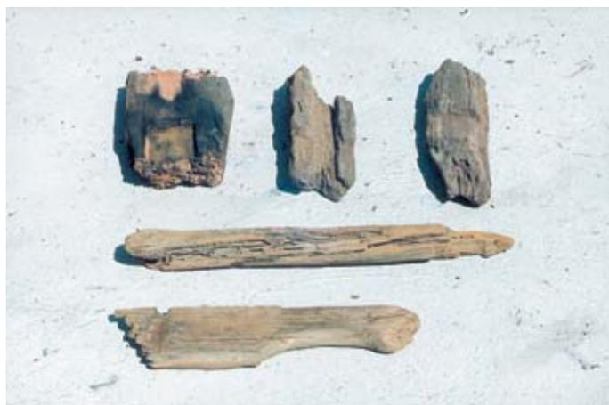
**Foto 18** Restos de un árbol rotor. En la parte inferior, trozos de una vara y palanca de alivio.
