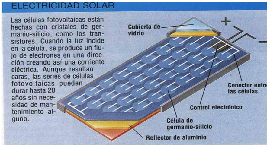
Existen dos tipos de aplicaciones de este tipo de energía. Una sirve para los lugares aislados en donde la electricidad no existe, la energía solar se almacena en unas baterías y se aprovecha cuando hay demanda (proyectos de desarrollo rural, escuelas, hospitales...). La otra utilización, para núcleos mayores, necesita una central o planta de producción.
