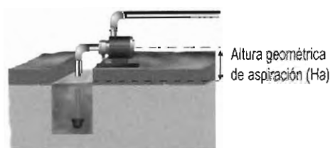
Figura 6. Representación esquemática de la altura geométrica de aspiración.
