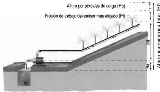
Figura 8. Representación esquemática de la altura manométrica total.
