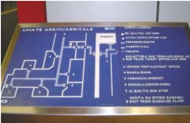
Plano de orientación en altorrelieve y braille del Aeropuerto de Linate, Milán
