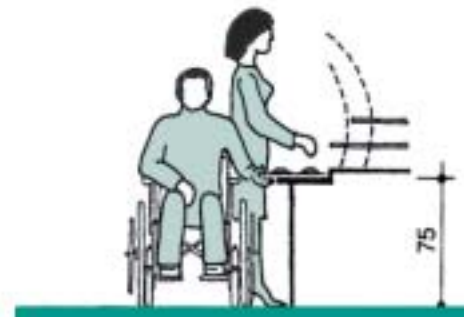
Dimensiones básicas de una barra de autoservicio
