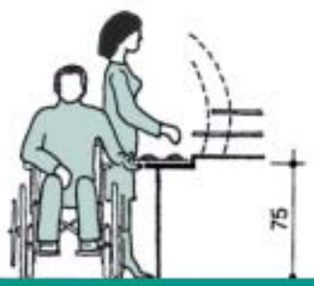
Dimensiones básicas de una barra de autoservicio para la aproximación lateral de una persona en silla de ruedas
