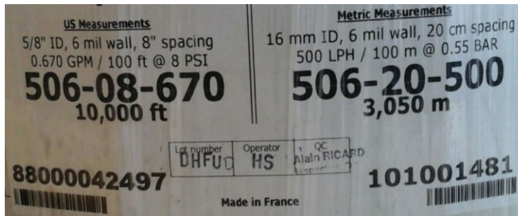
Figura 5. Etiqueta de cinta de riego con información sobre el caudal
