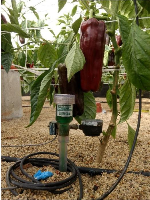
Figura 3. Electrotensiómetro para la gestión automática del riego.
