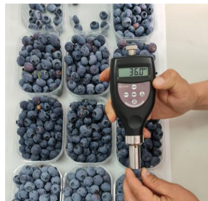
Figura 6. Equipo utilizado para estimar la dureza del fruto.
