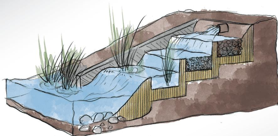
Figura 9. Ejemplo de canal escalonado para evitar que la entrada de agua canalizada a una balsa o charca artificial erosione el fondo. Fuente: Camacho y col., (2011).
