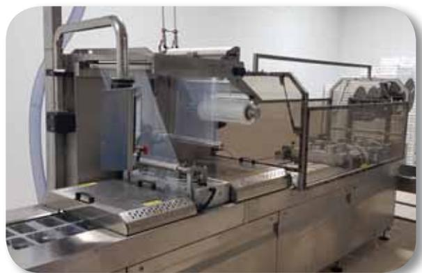
Figura 91. Termoformadora termoselladora
