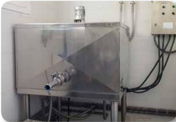
Figura 33. Lactofermentador en plataforma que permite el embotellado de yogur y leche fermentada
