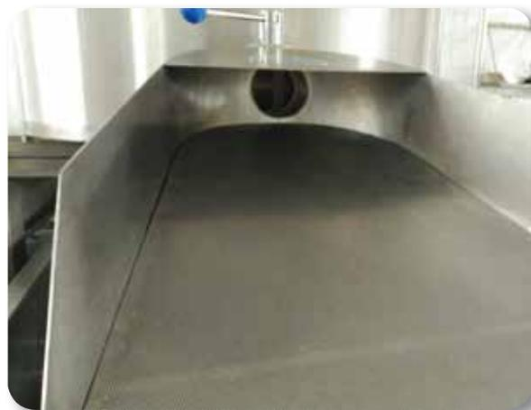
Figura 37. Chapa microperforada del zapatón que permite el drenaje del suero
