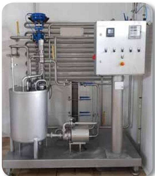
Figura 22. Pasteurizador de placas
