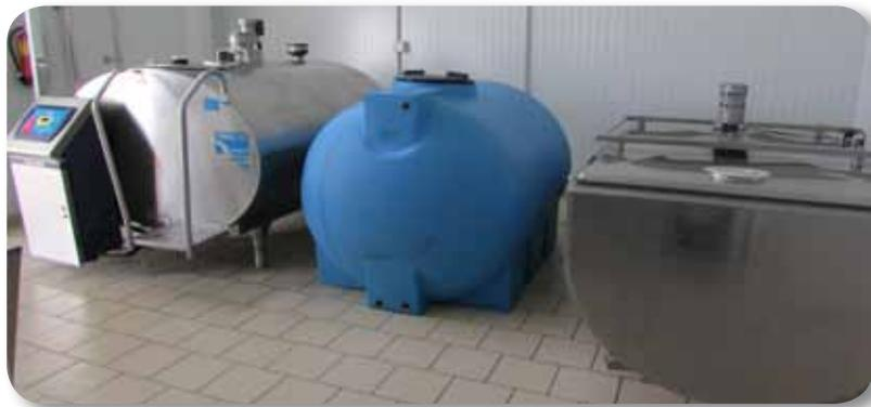
Figura 10. Sala de recepción con dos tanques autorefrigerantes y depósito de suero
