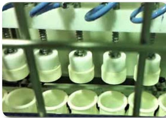
Figura 65. Extracción de los quesos del molde por vacío
