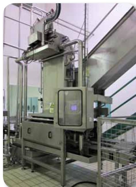
Figura 54. Llenadora automática de moldes
