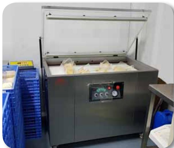
Figura 90. Envasadora al vacío
