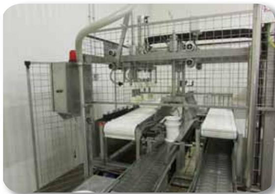
Figura 64. Desmoldeadora automática
