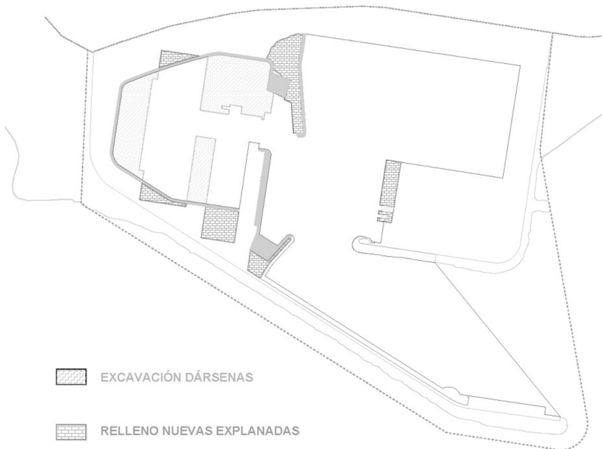
La ordenación propuesta implica la excavación de una superficie total en torno a los 31.700 m<sup>2</sup> para la conformación de la nueva dársena náutico-recreativa y el relleno de distintos espacios para la formación de nuevas explanadas, actuando en una extensión global próxima a los 16.200 m<sup>2</sup>. Del mismo modo, el nuevo contorno portuario interior implica obras de abrigo, taludes y rampas que significan la modificación de la
