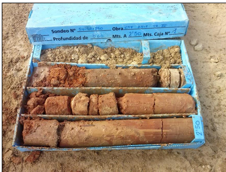
Foto 4. Secuencia estratigráfica obtenida con la perforación.
