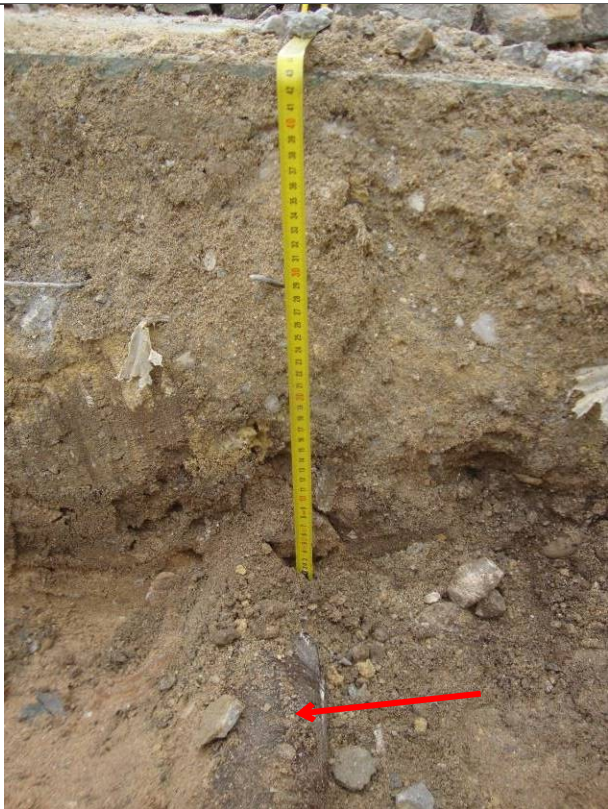
Estratigrafía: hormigón, relleno y tubería.
