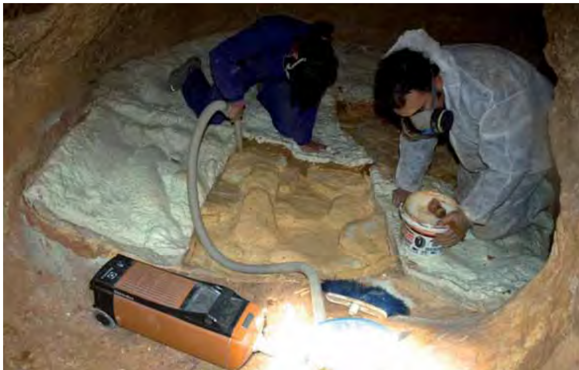
Lámina 10.18. Limpieza de la superficie del elastómero previa a la proyección del poliuretano.
