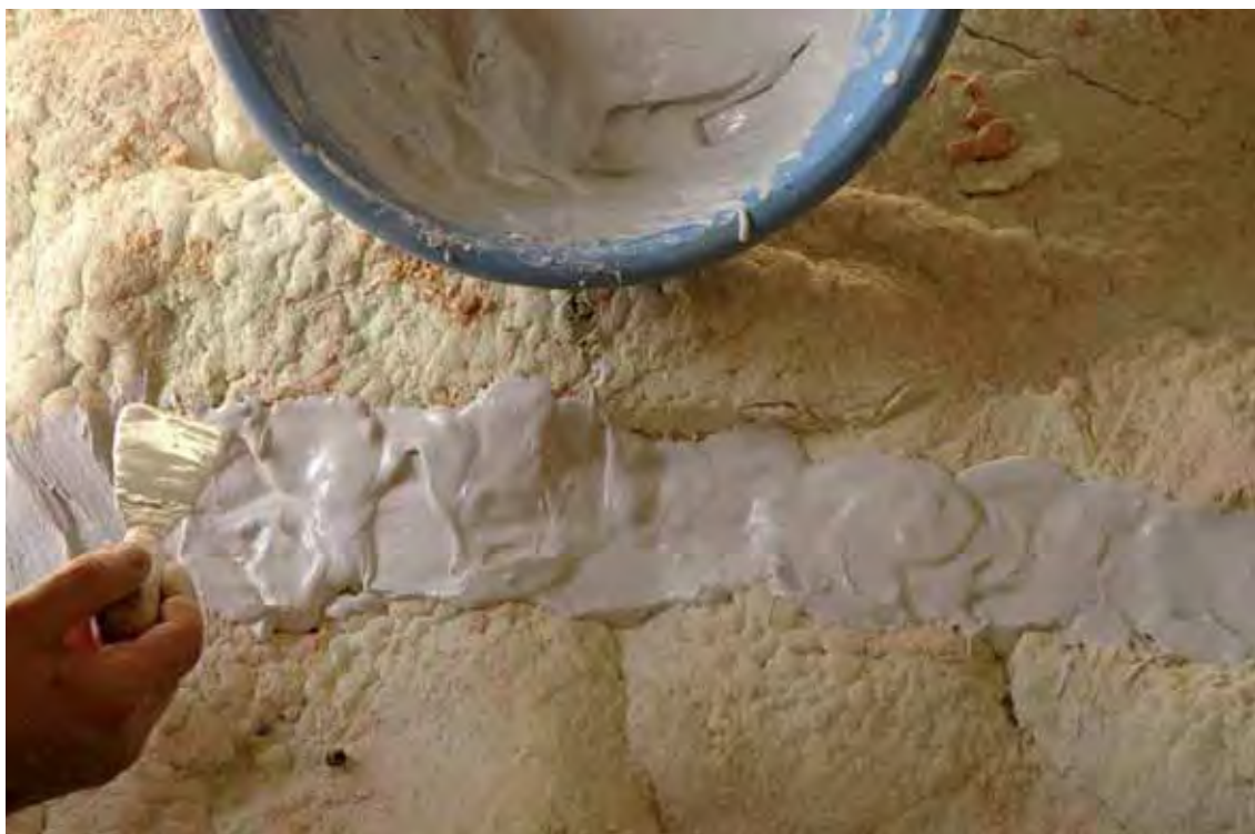
Lámina 10.41. Aplicación de yeso sobre la cara externa en una línea de división de dos piezas.
