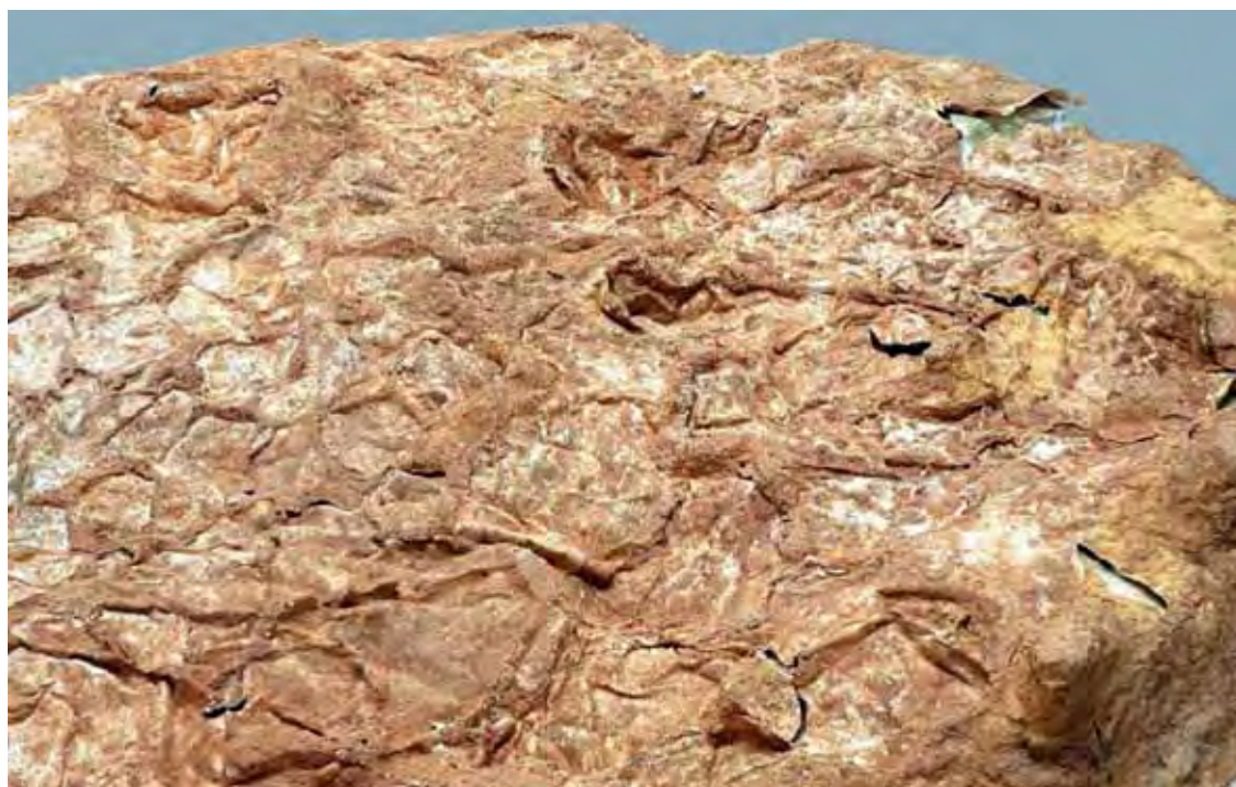
Lámina 10.52. Detalle del aspecto de la silicona en su ubicación sobre la madre-forma. Se aprecian pliegues y cortes.
