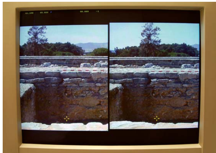
322.- Par fotográfico para restitución fotogramétrica. Detalle de la cara exterior del muro norte de la celda del templo.
