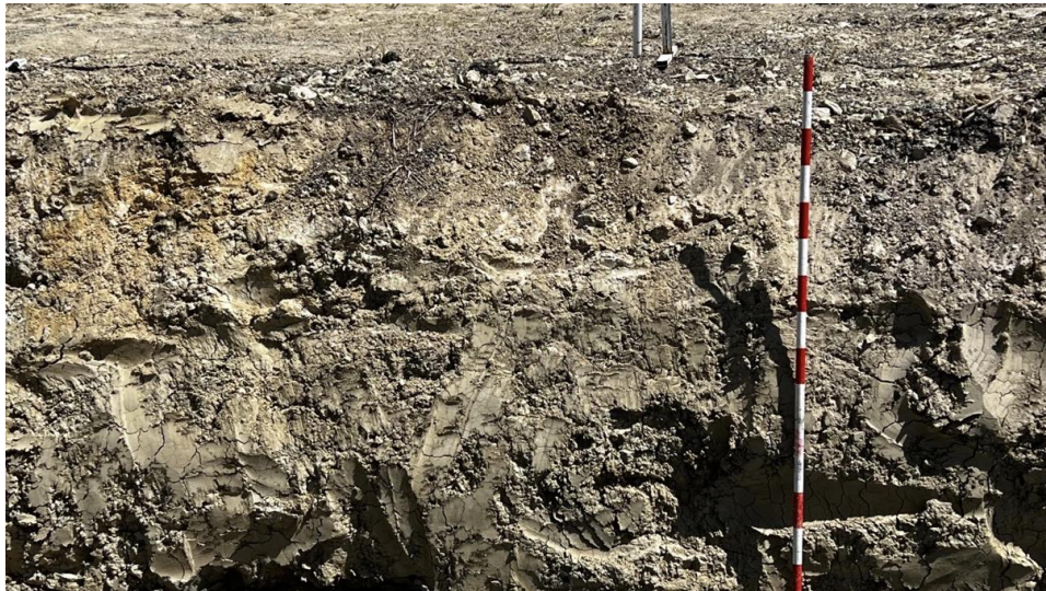
Perfil estratigráfico del sondeo del Colector de Impulsión I2 de la EBAR del Polígono
