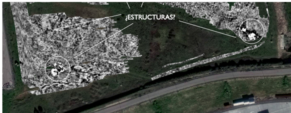
Ilustración 7. Detalle del mapa de radar de fase a -24 cm y señalización de anomalías de interés en las esquinas sureste y suroeste de la parcela
