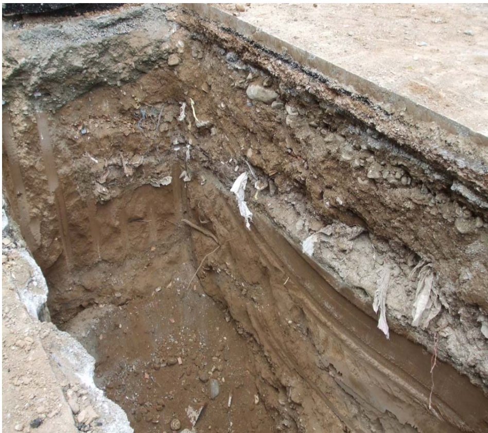
Perfil. Calle Mencía Calderón. Obsérvese la capa de escombros.
