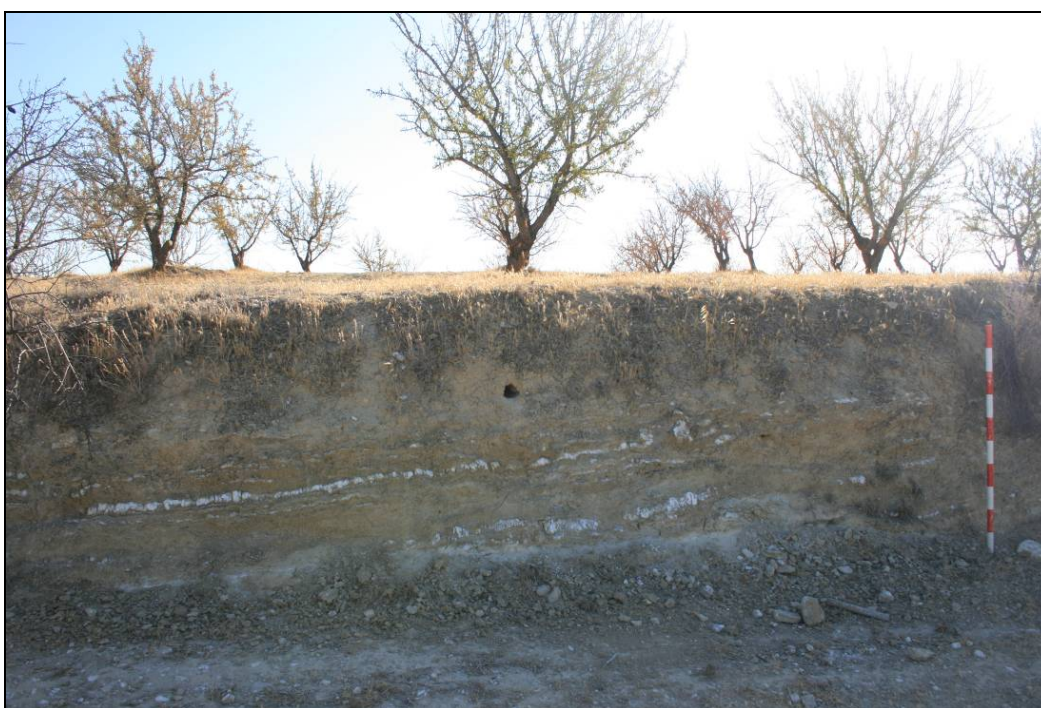
Foto 6. Detalle de la secuencia estratigráfica documentada en el terreno ( P.K. 2+500 ). Obsérvese que bajo el estrato superficial correspondiente a la puesta en cultivo del terreno, se registra el nivel de arenisca y yesos característico de esta zona.
