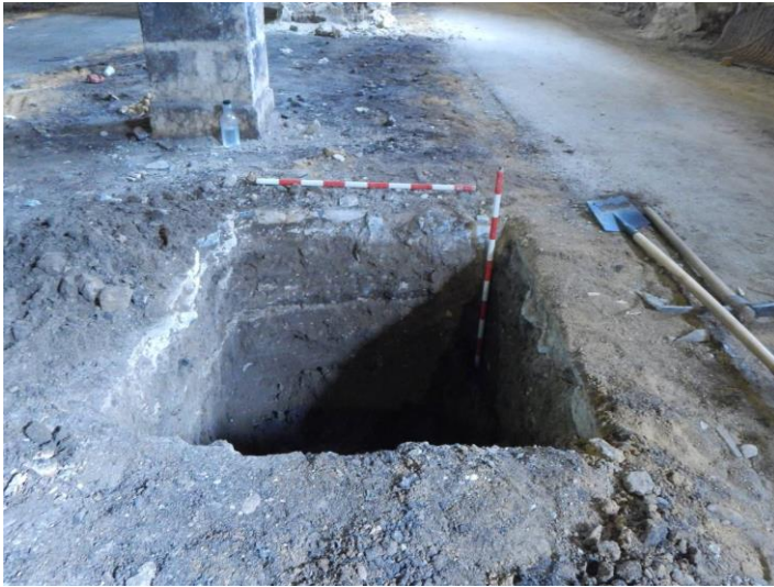
Detalle de sondeos manuales. Puede apreciarse la misma estratigrafía.
