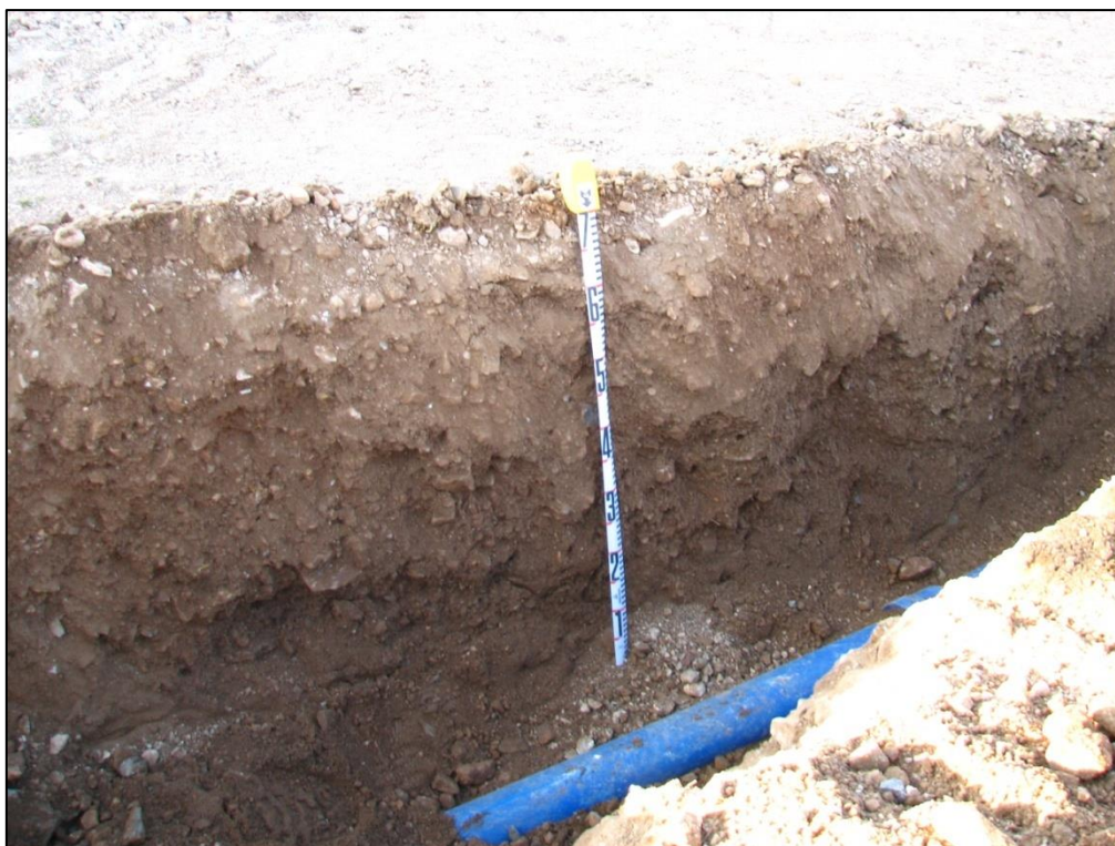
Fig. 21: perfil del sondeo 13.
