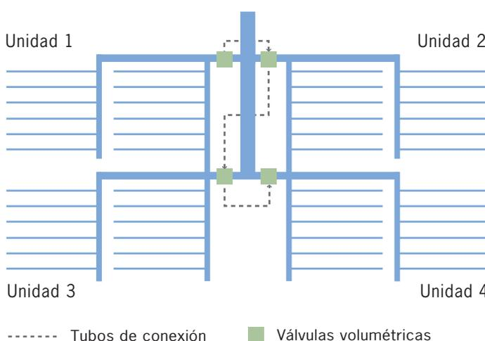
Figura 14. Esquema del funcionamiento de un riego con satélite
