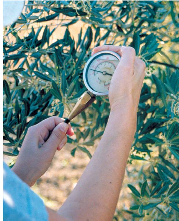
Figura 9. Medida de la presión del agua (utilizando un manómetro) en un tubo de inserción de un gotero.
