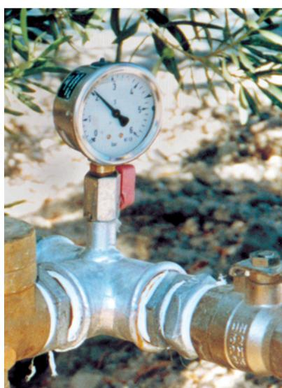
Figura 2. Manómetro tipo Bourdon.
