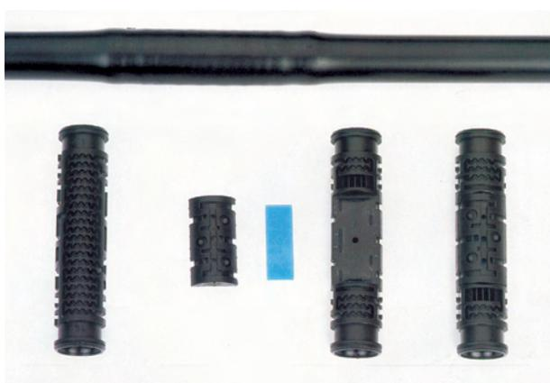
Figura 25. Despiece de un gotero integrado autocompensante. En el centro, la membrana elástica que produce el efecto de autocompensación.
