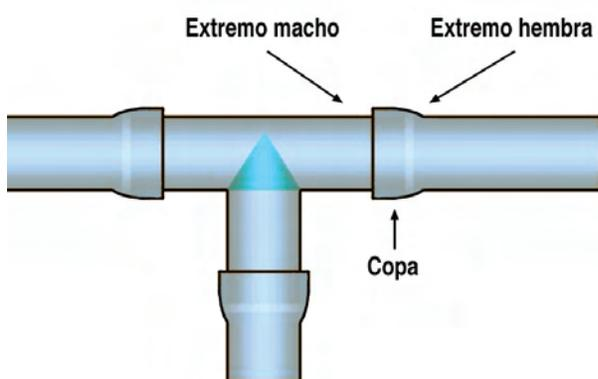
Figura 16. Ejemplo de una unión de tuberías de PVC por encolado.
