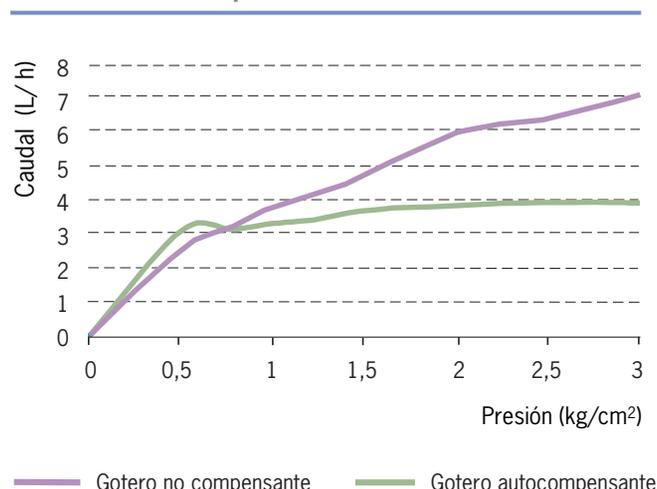
Obsérvese cómo el autocompensante suministra un caudal aproximado de 3 litros por hora en el intervalo de presiones entre 0.5 y 3 "kilos".
