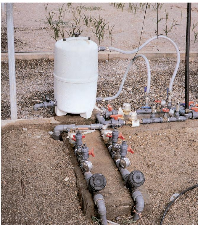
Figura 13. Fertilización usando un tanque fertilizante.
