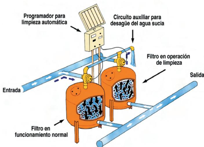
La arena a utilizar debe ser **silícea, uniforme y con un tamaño igual al de paso del agua en el emisor**, con objeto de retener partículas de ese tamaño que pudieran provocar obturaciones. Los filtros de arena no deben instalarse después del equipo de fertirriego para evitar que proliferen microorganismos en la arena.
