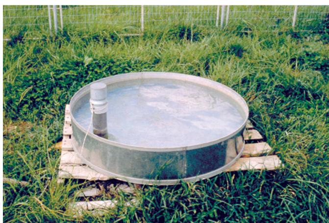
Figura 2. Tanque evaporimetro clase “A” para medir la evapotranspiración de referencia (ETr).
