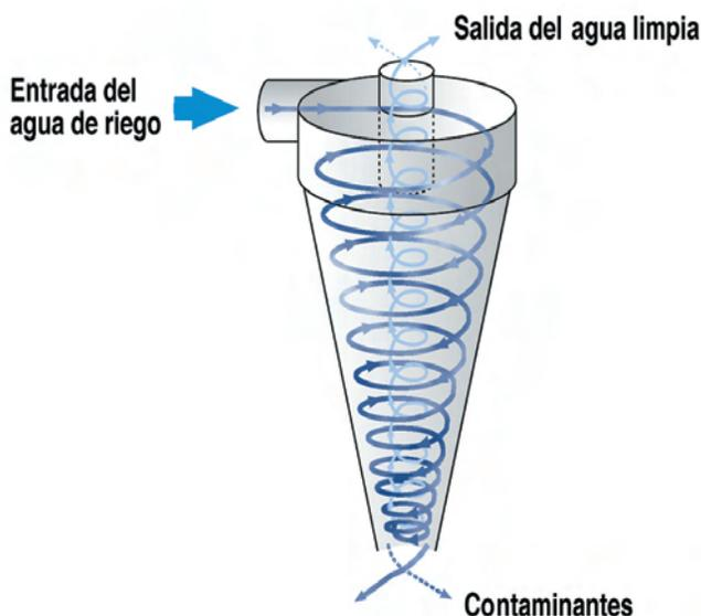
llevar partículas de arena o limo por lo que deben colocarse uno o varios **hidrociclones** a la entrada al cabezal para eliminar estas partículas sólidas.
