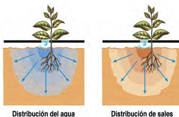
Figura 7. **Distribución típica de las sales en riego localizado**
