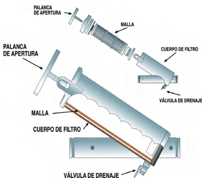
A continuación del hidrociclón se instala el equipo de fertirriego (si no es necesario un filtro de arena) y posteriormente uno o varios filtros **de malla o de anillas** (a elección del usuario) que tienen una utilidad y funcionamiento muy similar. Este orden debe ser invariable, para que los filtros de mallas o anillas retengan los precipitados o impurezas del abono.
