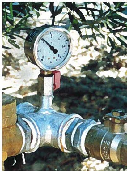
Figura 2. Manómetro tipo Bourdon.
