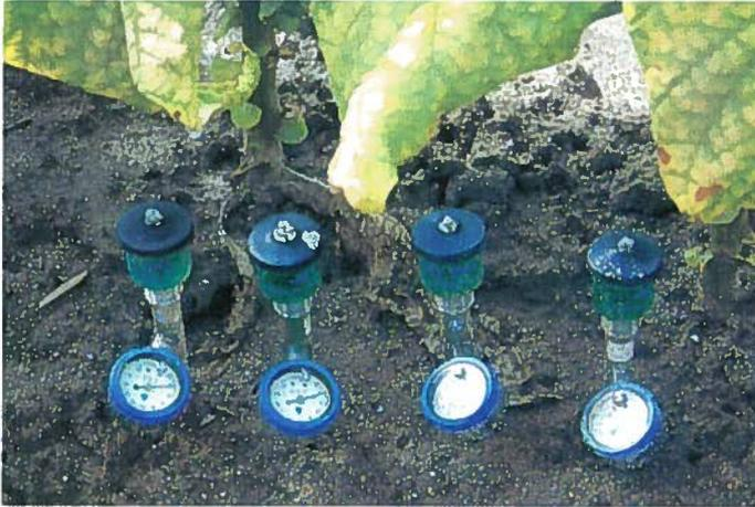
Figura 12. Parejas de tensiómetros colocados a distintas profundidades. En riego localizado se utilizan básicamente para comprobar si el volumen de agua aportado en el riego es el adecuado.
