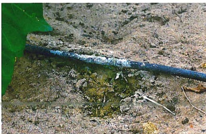
Figura 4. Residuos de sales en torno a un emisor de riego, que provocan un aumento de salinidad del suelo y eleva el riesgo de obturación del gotero.
