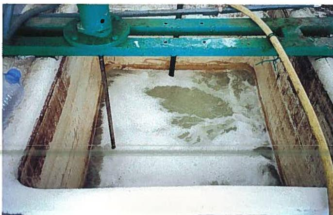
Figura 10. Tanque fertilizante. Se observa el agitador, accionado por un motor eléctrico, usado para homogeneizar la solución nutritiva.
