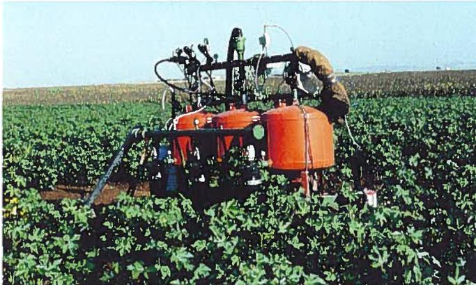
Figura 1. Cabezal de riego localizado.
