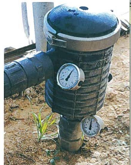
Figura 3. Medida de la presión a la entrada y salida de un filtro de anillas utilizando manómetros.
