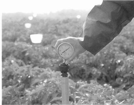
Figura 2. Medida de la presión en la boquilla de un aspersor utilizando un manómetro.
