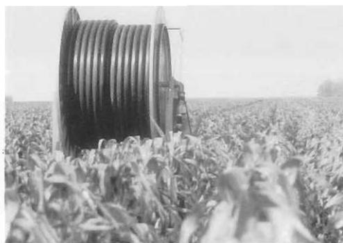
Figura 24. Cañón de riego tipo enrollador.
