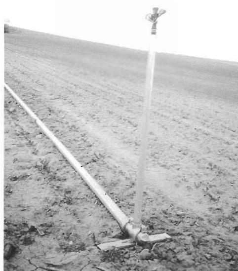
Figura 9. Tubo portaaspersor en el que se observa el estabilizador.
