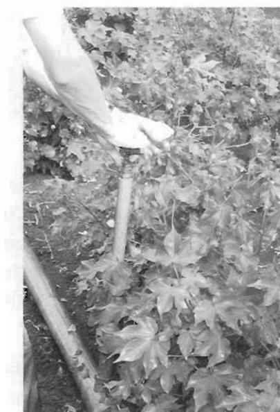
Figura 8. Medida de la presión en un aspersor utilizando un manómetro.
