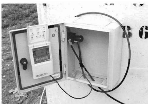
Figura 10. Programador de riego para una automatización sencilla del riego.
