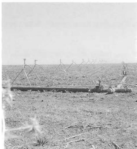
Figura 21. Sistema de aspersión semifijo con mangueras desplazables.
