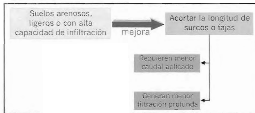
Figura 8. Efectos de la reducción de la longitud de las unidades de riego en suelos ligeros con alta capacidad de infiltración de agua.
