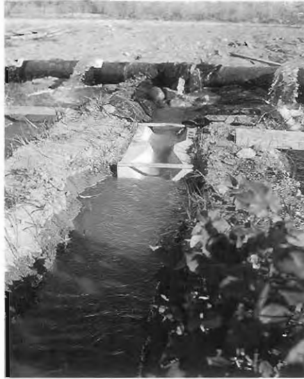
Figura 8. Aforador de estrechamiento colocado en cabecera de un surco de riego para medir el caudal aplicado.
