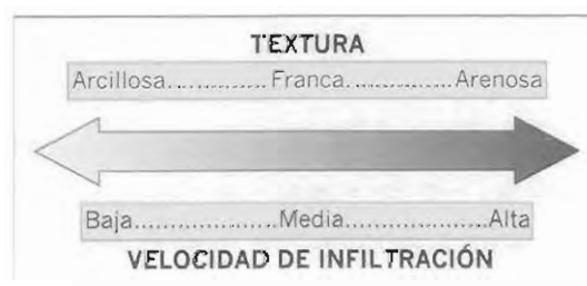
Figura 7. Relación entre la textura del suelo y su velocidad de infiltración de agua.
