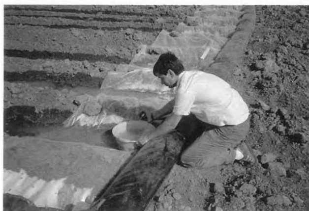
Figura 20. Medida del caudal de entrada a un surco utilizando un recipiente de volumen conocido y un cronómetro.
