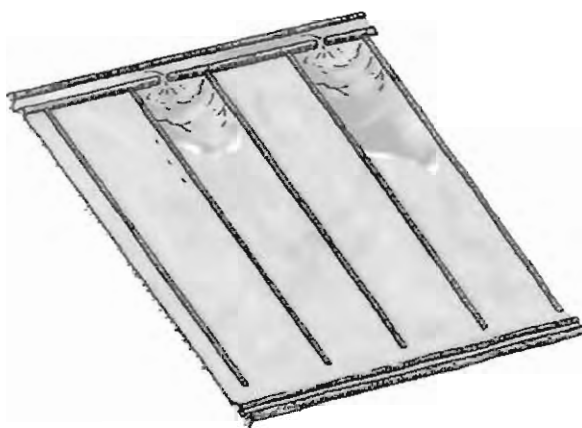
Figura 6. Riego por fajas, con acequia de abastecimiento en la cabecera y desagüe en cola.
