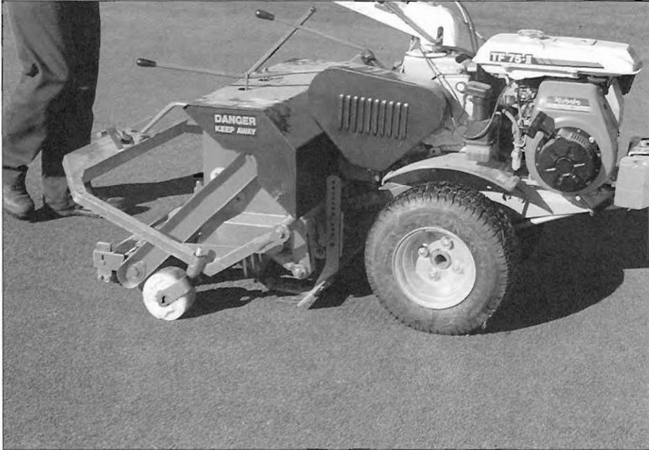
*Un terreno encesgado. En la foto vemos una maquinaria para "pinchar" suelos compactados en profundidad.*
