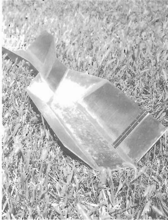
FIGURA 1. Perspectiva del aforador.
