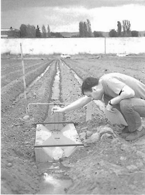
FIGURA 6. Utilización evaluando un riego.
